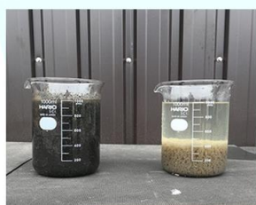
汚泥を沈殿させる
